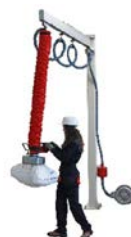
Complementi: manipolatore per agevolare il sollevamento dei sacchi
