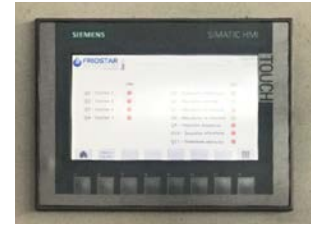
Pannello touch Siemens per il controllo e la regolazione di tutti i parametri di funzionamento
