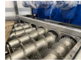
Particolare coclee elicoidali a passo variabile per non comprimere il ghiaccio
