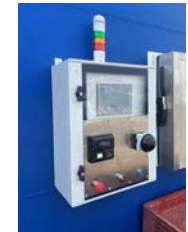
Quadro operatore semplice e intuitivo. Lo schermo indica costantemente lo stato dell'impianto e le istruzioni per l'operatore
