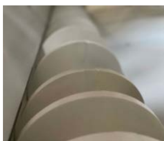
Extraction par vis sans fin à pas variable en matière plastique alimentaire
