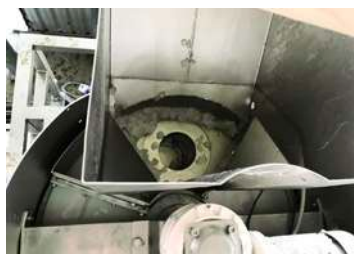
▲ particolari di dosatore a tazze e sua posizione lungo la linea ▼ nastro in uscita dopo il dosatore
