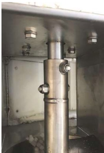
▲ particolari di dosatore a tazze e sua posizione lungo la linea ▼ nastro in uscita dopo il dosatore
